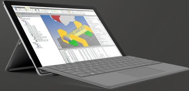
关于加工中心的编程，Emmegi 提供 CAMplus软件（可与 Shape、DriverCAD 和 DriverCL 附加模块集成）。CAMplus能够以三维图形方式进行加工编程，显示型材和刀具。该软件包括最常见的图形（孔、槽、矩形等），可以通过附加的 Shape选项进行扩展，拓展后可以自定义任何形状的图形。使用 DriverCAD 选项，可以导入用三维 CAD 程序制作的项目。对于门窗行业的从业者来说，CAMplus与 EmmegiSoft 的 FP Pro 计算软件可以完全集成，也可以通过 DriverCL 选项与市场上最流行的软件对接。
