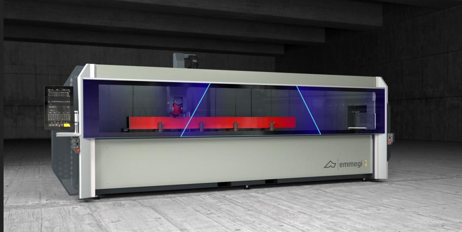
带有 4 个控制轴的数控加工中心、专门用于加工铝、PVC、一般轻合金和钢材质的棒材或工件、长度不超过 4 米。机床配有独立电动虎钳、可以在攻丝时间内进行虎钳定位。第 4 数控轴允许电动主轴在水平轴的  $-120^{\circ}$  到  $+120^{\circ}$  范围内旋转并定位在任何中间角度位置。
