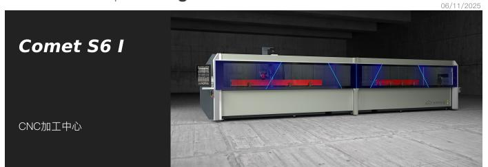
带有 4 个控制轴的数控加工中心、专门用于加工铝、PVC、一般轻合金和钢质棒材或工件。加工中心有两种工作模式:一种是单加工区、用于加工长度不超过 7 米的棒材、另一种是交替模式下的两个独立加工区。机床配有独立电动虎钳、可以在动态交替模式工作过程的攻丝时间内进行虎钳的定位。第 4 数控轴允许电动主轴在水平轴的 -120°到 +120°范围内旋转并定位在任何中间角度位置。
