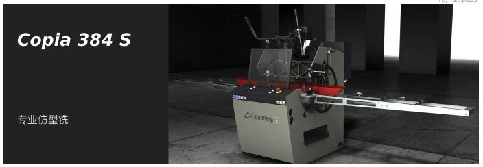
手动控制的单头受电弓、可以进行气动夹持并通过间接杠杆平移切割头。可以加工最大尺寸为 2 毫米的钢材和寸为 2 毫不锈钢(选配)。配备了夹持台旋转系统、机床可以加工型材的 4 个面、无需松开虎钳、或进行通体式加工、可在 90°扇形范围内旋转 270°。四个气动挡板确保夹紧型材。加工区域配有气动保护装置。旋转装置能够提高加工速度和精度、通过取消通体式加工来使用更短的刀具、并可以减少振动和噪音。
