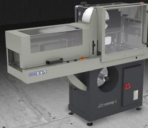
在铝型材上粘贴保护膜的机床。型材由电动辊筒自动送入，并通过压力辊筒确保薄膜与型材完美粘合。额外的选配套件还允许同时将薄膜粘贴于第三个面。
