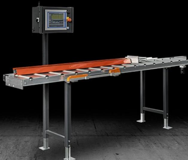
测量反馈和型材支撑系统配有止动件在数控轴上的移动装置、以及通过编码器进行读数的电子读数装置。配有电子测量系统、可以将数据保存在内存当中、或者通过蓝牙将数据实时传输到电脑或切割机的控制单元中。可以实现加工定位的高精度和可重复性。
