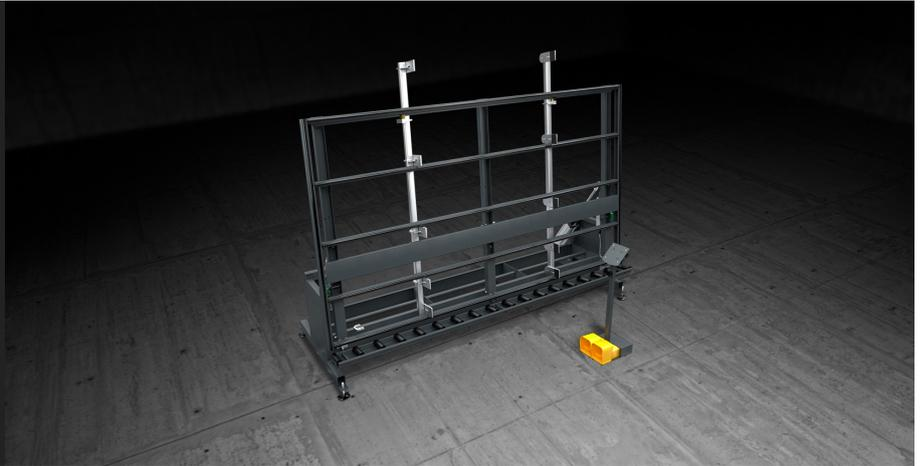
一种铝制窗框的测试台，可以再现窗框的使用条件：通过一个可调节的虎钳系统在窗框的整个高度对其进行夹持，将窗板插入窗框内，安装玻璃，并进行最后的测试。辊筒输送机允许操作员完全自主地装卸重型窗框。
