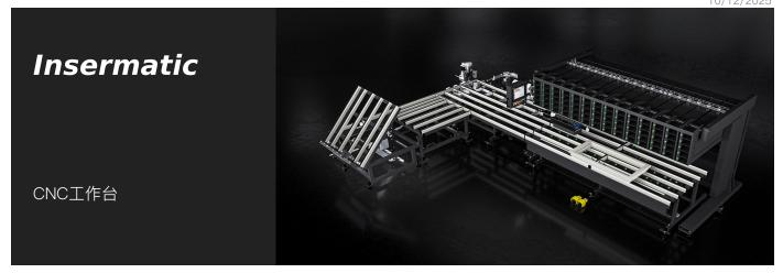
自动工作台用于将恒定或可变螺距的五金件拧到窗框上、工作台面宽大、可移动和旋转大型窗框。
