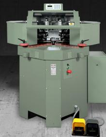
此机床拥有两个特殊操作头、上面配备了可以调节到所有倒角位置的 2 个倒角刀。倒角刀可以在 Y 轴（沿型材）、Z 轴（上下）和 X 轴（沿倒角方向）上移动并调整。无论加工何种类型的型材、这样的条件都可以避免在机床上更换刀具。这样就可以减少安置的时间和成本。
