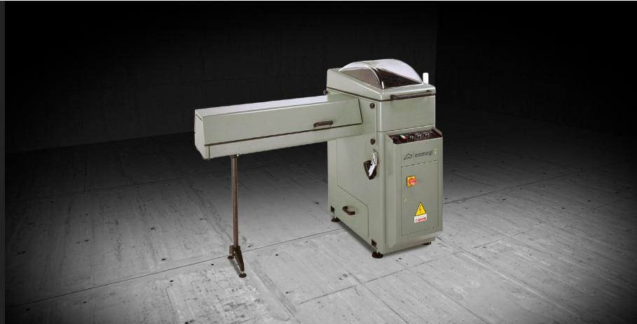
水平端面铣削机，带电动气动进给装置。方框外铣削角度 +45°/90°/-45°。刀具的高速旋转提高了对方框外喷涂型材的加工质量。气动控制的铣刀组件快速更换装置。防刮加工台面。全封闭隔音加工区，内侧可视范围宽。手动控制的隔音隧道（L=1,100 毫米），将机床发出的噪音降低到约 85 分贝（仅在 90° 角铣削时）。
