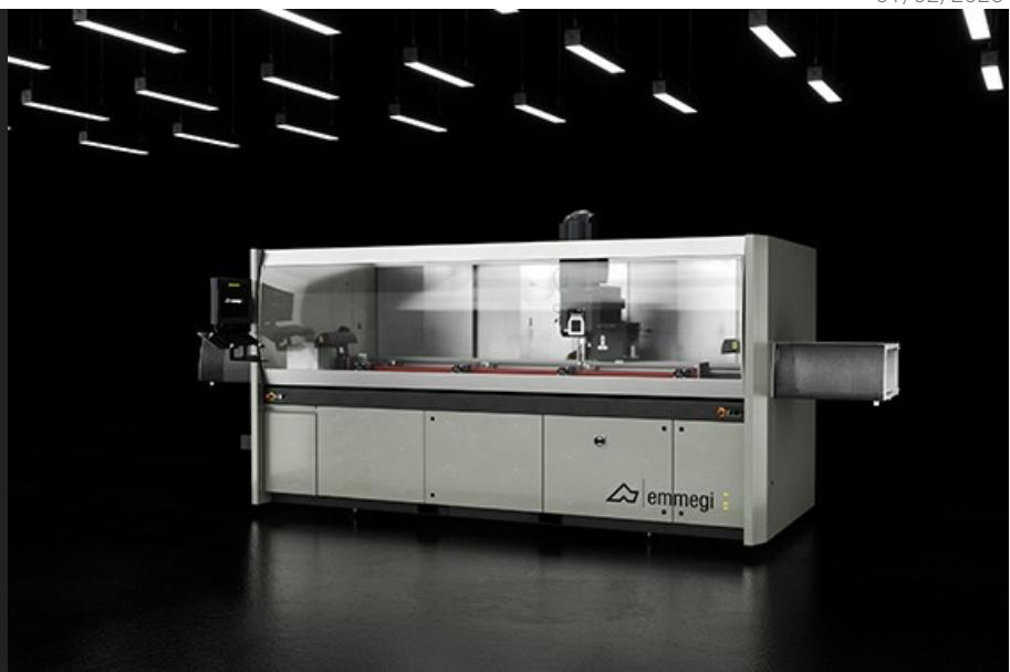
带有 3 个控制轴的数控加工中心，刀具可以在三个固定位置上自动旋转，从而对工件的 3 个面进行加工。
