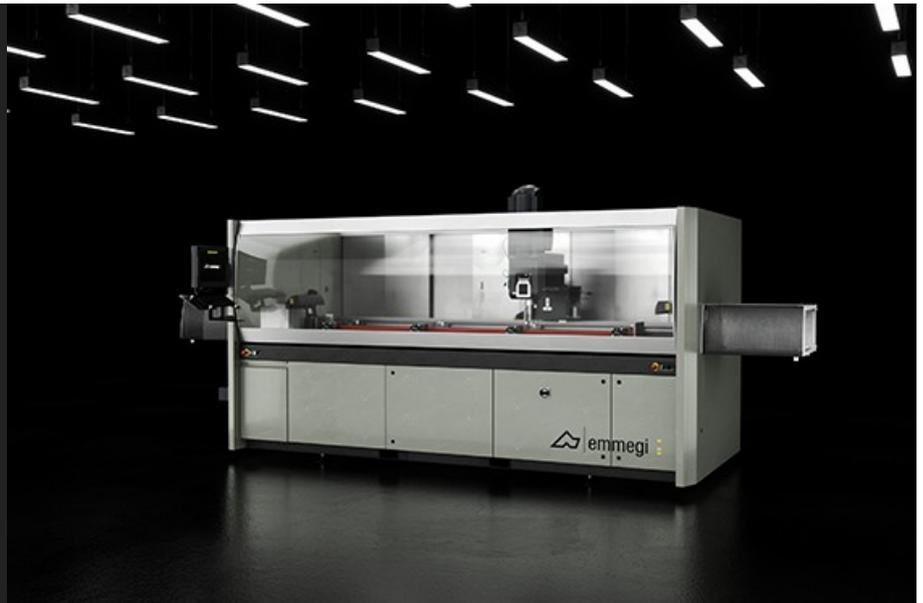
带有 3 个控制轴的数控加工中心，刀具可以在三个固定位置上自动旋转，从而对工件的 3 个面进行加工。
