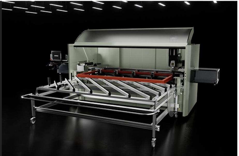
4 控制轴数控加工中心配有自动刀具旋转装置、可以对工件的 3 个面进行加工。专门用于加工铝制、PVC、常见轻质合金及 2 mm 及以下厚度的钢制型材或工件。正面的可拆卸装料台装有轮子、方便移动、可以向机床装载已经组装好的方框并对其 4 边进行加工。配有一个 9 位手动刀具库和一个位于防护舱左侧的 4 位自动刀具库。另外、可以选配一个安装在防护舱右侧的 4 位自动刀具库。通过左侧的气动挡块来完成型材或方框的定位、通过 X 轴自动定位的 4 个坚固虎钳进行夹持。可以在右侧选配安装另一个气动挡块、对超过加工范围两倍长度的超尺寸棒材进行加工。所有 CN 轴都是绝对轴、机器重新启动时不需要归零。此外还配有活动加工平面、方便工件装/卸、显著增加可加工范围。
