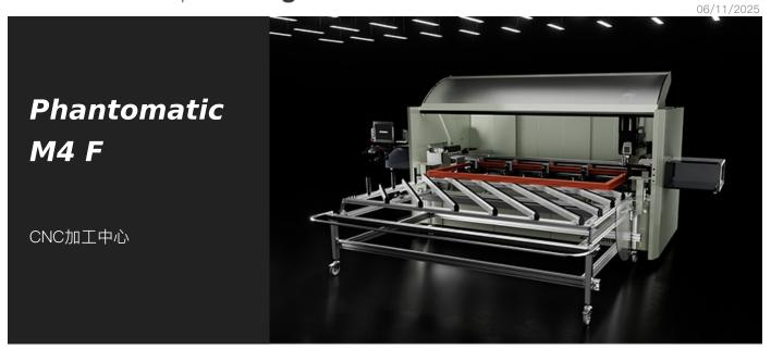
4 控制轴数控加工中心配有自动刀具旋转装置、可以对工件的 3 个面进行加工。专门用于加工铝制、PVC、常见轻质合金及 2 mm 及以下厚度的钢制型材或工件。正面的可拆卸装料台装有轮子、方便移动、可以向机床装载已经组装好的方框并对其 4 边进行加工。配有一个9位手动刀具库和一个位于防护舱左侧的4位自动刀具库。另外、可以选配一个安装在防护舱右侧的4 位自动刀具库。通过左侧的气动挡块来完成型材或方框的定位、通过 X 轴自动定位的 4 个坚固虎钳进行夹持。可以在右侧选配安装另一个气动挡块、对超过加工范围两倍长度的超尺寸棒材进行加工。所有 CN
