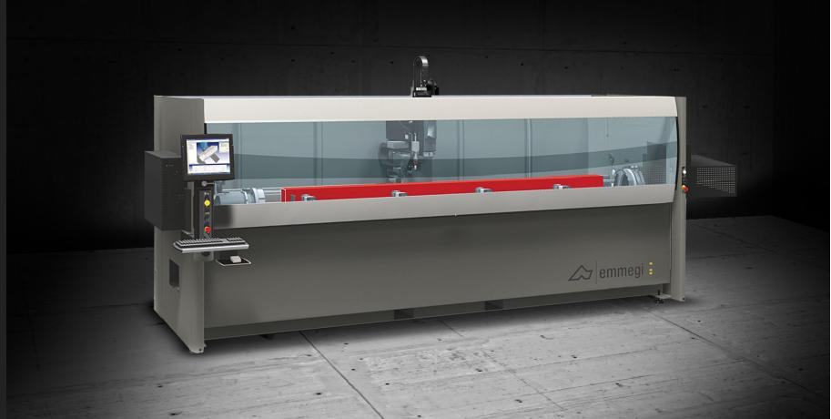
带有 4 个控制轴的数控加工中心、专门用于加工铝、PVC、一般轻合金和 3 毫米及以下钢材质的棒材或工件。配有一个 4 刀位的刀具库、可以容纳 2 个转角单元和一个圆盘铣刀、用于加工工件的 5 个面。机器包含的旋转工作台面（数控轴）可以执行从 – 90° 到 + 90° 的任何角度的加工、并且可以在台面位于 0° 位置时、对带有双输出转角单元的两个顶端进行加工。所有数控轴都是绝对轴、在机床重新启动时不需要重新设置。
