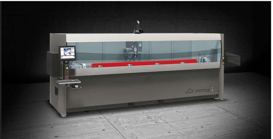
带有 4 个控制轴的数控加工中心、专门用于加工铝、PVC、一般轻合金和 3 毫米及以下钢材质的棒材或工件。配有一个 4 刀位的刀具库、可以容纳 2 个转角单元和一个圆盘铣刀、用于加工工件的 5 个面。机器包含的旋转工作台面（数控轴）可以执行从  $-90^{\circ}$  到  $+90^{\circ}$  的任何角度的加工、并且可以在台面位于  $0^{\circ}$  位置时、对带有双输出转角单元的两个顶端进行加工。所有数控轴都是绝对轴、在机床重新启动时不需要重新设置。
