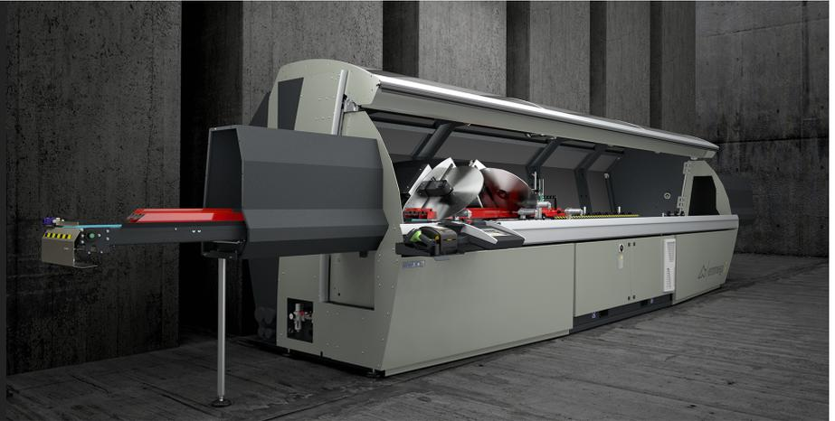
带 5 个控制轴的双头切割机、用于切割铝、和轻合金、移动切割头自动移动、从 22°30'（内侧）到 45°（外侧）的所有角度均实现高精度电子化管理、每个角度内有 280 个位置。600 毫米的硬合金刀片可在两种不同模式下推进。标准进给优化了垂直方向的切割形状、能够切割高度超过 450 毫米的型材。径向模式利用超出垂直参考平面的宽大行程、在水平方向上生成一个宽阔的曲线。这一解决方案允许切割宽度 240 mm 及以下的型材。机器有两个版本：PRECISION RS L 用于切割截面较大、正常厚度的轻质型材；PRECISION RS H 用于切割抗切割性能较高、厚度较大、或其几何形状需要刀片接触弧长较大的重型型材。刀片的进给由一对 CN 轴驱动、以保证对刀片的速度和离开路径的最佳调节。HS (High Speed) 版本具有更高的 X 轴速度和所有必要的保护措施、甚至可以在无人值守的状态下进行自动加工。
