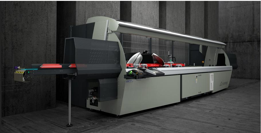
带 5 控制轴的双头切割机，用于切割铝、PVC 和轻合金，移动切割头自动移动，从 45°（内侧）到 15°（外侧）的所有角度均实现高精度电子化管理，每个角度内有 280 个位置。在基本版本中，刀片进给由一对气动油压缸驱动。在 E 版本中，刀片进给也由一对数控轴管理，能够以最佳方式调节刀片速度和行程。刀片 550 毫米。可提供 5 米或 6 米的有效切割长度。HS (High Speed) 版本具有更高的 X 轴速度和所有必要的保护措施，甚至可以在无人值守的状态下进行自动加工，实现最大的生产效率。
