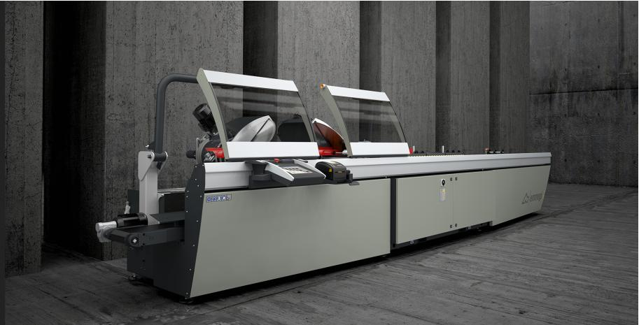
带有 3 个控制轴的双头切割机、移动切割头自动移动、从 45°（内侧）到 15°（外侧）的所有角度均实现高精度电子化管理、每个角度内有 280 个位置。刀片进给由一对气动油压缸驱动。
