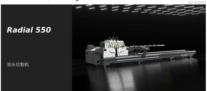
电子双头切割机、刀片可径向移动、活动切割头通过齿条和小齿轮系统在滚珠滑块上自动移动;向内侧翻转角度可达 30°、设计用于切割大型型材。刀片进给由一对气动油压缸驱动。
