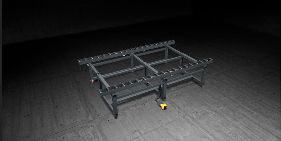
专门用于外墙单元在生产线中装配和移动的大尺寸模块化工作台，配备两条辊筒轨道，上面覆盖着软质的 PVC 护套；两条轨道之间的距离可根据待加工窗框的宽度手动调节。一个可气动操纵的系统能够在加工阶段锁定辊筒。
