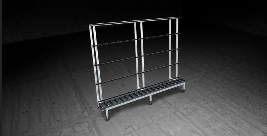
垂直辊筒输送机，即使是非常重的框架和窗框也能在不同的装配工位之间轻松转移。
