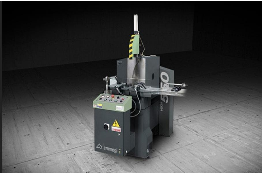
带正面刀片的单头切割机，左侧装载，气动控制的双侧翻转装置可以翻转到以下固定位置：左侧 45° 和 90°，右侧 45° 和 22°30'。借助一个特殊的机械止动件也可以在中间角度进行切割。
