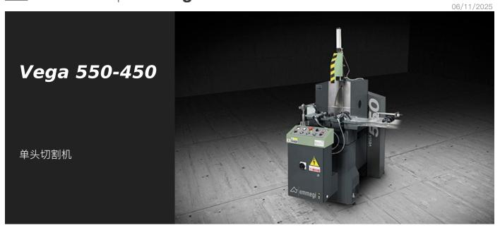
带正面刀片的单头切割机,左侧装载,气动控制的双侧翻转装置可以翻转到以下固定位置:左侧 45°和 90°,右侧 45°和 22°30′。借助一个特殊的机械止动件也可以在中间角度进行切割。
