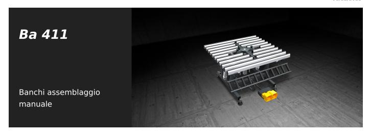
Banco per l'assemblaggio di ante con vetro con piano di lavoro inclinabile da 0° (orizzontale) a 85°. La rulliera a scomparsa è regolabile in altezza (da 170 a 460 mm) indipentemente dal piano di lavoro. Il piano di lavoro è regolabile da 895 a 965 mm e i piedini sono provvisti di fori per il fissaggio a terra. Viene corredato di una crociera centrale per il sollevamento ed il posizionamento del vetro.
