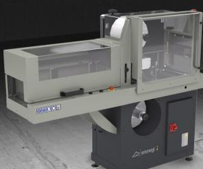
Macchina per l'applicazione di una pellicola protettiva su profilati di alluminio. L'avanzamento del profilo avviene in automatico mediante rulli motorizzati e la perfetta adesione della pellicola al profilato è garantita mediante rulli pressori. Un kit opzionale aggiuntivo consente di applicare la pellicola al contempo anche su una terza faccia.
