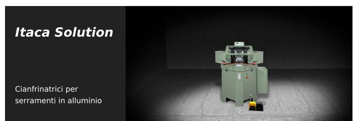
La macchina ha due teste operatrici particolari equipaggiate con masse in cui i 2 coltelli sono regolabili su tutte le posizioni di cianfrinatura. I coltelli si spostano e sono regolabili sull'asse Y (lungo il profilato), sull'asse Z (alto-basso) e sull'asse X (lungo la direzione di cianfrinatura). Queste condizioni evitano la sostituzione sulla macchina degli utensili indipendentemente dai diversi tipi di profilato. Si riducono, così, i tempi ed i costi di piazzamento.
