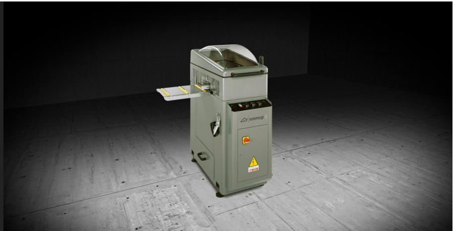
Intestatrice orizzontale ad avanzamento manuale. Fresatura fuori quadro +45° / 90° / -45°. Alta velocità di rotazione utensile per migliorare la qualità della lavorazione sul profilato verniciato e fuori quadro. Cambio rapido del gruppo frese con comando pneumatico. Piano di lavoro antigraffio. Zona lavoro integralmente carenata ad ampia visibilità interna.
