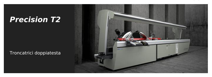
Troncatrice doppiatesta a 3 assi controllati per alluminio, PVC e leghe leggere, con movimento automatico della testa mobile e gestione elettronica di tutte le angolazioni da 45° (interni) a 15° (esterni) con una precisione, all'interno di ogni grado, di 280 posizioni. Nella versione base, l'avanzamento lama è azionato da una coppia di cilindri oleo-pneumatici. Lama da 550 mm. Disponibile con taglio utile di 5 m o 6 m di lunghezza.
