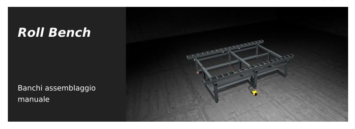
Banco modulare di grandi dimensioni dedicato all'assemblaggio ed alla movimentazione in linea di celle di facciata. È corredato di due piste di rulli ricoperti con guaina di PVC morbido; la distanza tra le due piste è regolabile manualmente in base all'ampiezza del serramento che si deve lavorare. Un sistema azionabile pneumaticamente consente di bloccare i rulli durante le fasi di lavoro.
