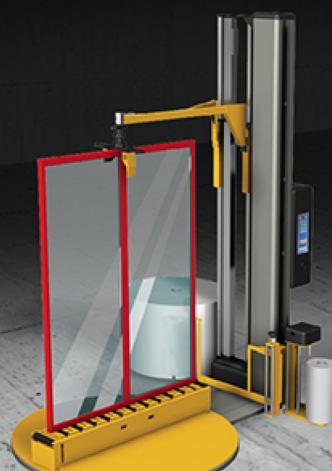
Imballatrice verticale per infissi. Il piano di appoggio è rotante ed è dotato di rulliera per facilitare la movimentazione di pezzi pesanti o di grandi dimensioni. La macchina è concepita per essere utilizzata da un solo operatore.
