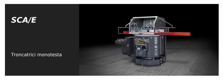
Troncatrice monotesta ascendente con rotazione automatica a CN dell'asse verticale mediante motore brushless e contemporaneo ribaltamento a comando idraulico dell'asse orizzontale. Tagli con angolazioni da 90° a 22°30′ (sinistra e destra) sull'asse verticale e da 90° a 35° (solo a destra) sull'asse orizzontale.
