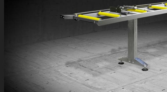
Estrutura em tubular de aço com pés ajustáveis e rolos de aço revestidos com PVC. Rolos de 240 mm., com comprimento da bancada de rolos de 3.500 mm., ou rolos de 440 mm. com comprimento da bancada de rolos de 4.000 mm.
