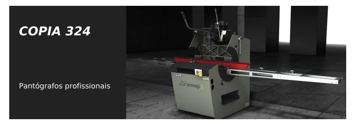
Pantógrafo monocabeça de comando manual com bloqueio pneumático e movimento de translação da cabeça através de alavanca indireta. Possibilidade de efetuar usinagens passantes em alumínio sem a necessidade de girar a peça. Plano de trabalho antirrisco. Apalpador com comando manual.
