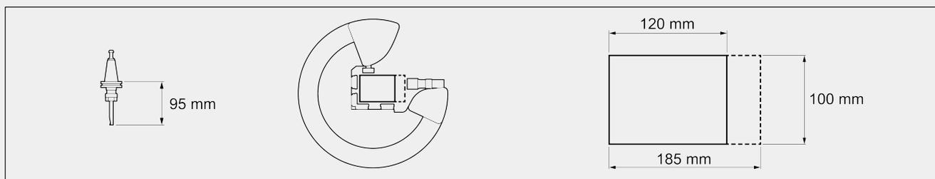
Secção máxima usinada nas 4 faces - L x H (mm)
