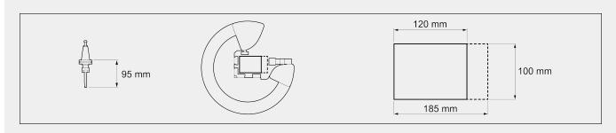
Secção máxima usinada nas 4 faces - L x H (mm) 120 x 100 Secção máxima usinada (parcialmente) na face superior - L x H (mm) 185 x 100 Largura Y usinada na face superior (mm) 120
