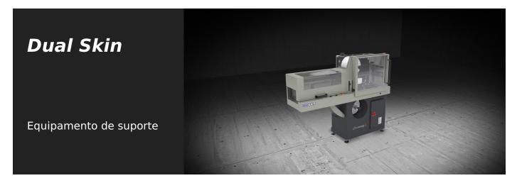
Máquina para a aplicação de uma película protetora sobre perfis de alumínio. O avançamento do perfil é feito automaticamente mediante roletes motorizados e a perfeita adesão da película ao perfil é garantida por intermédio de roletes prensadores. Um kit adicional, opcional, permite aplicar a película, simultaneamente, também sobre uma terceira face.
