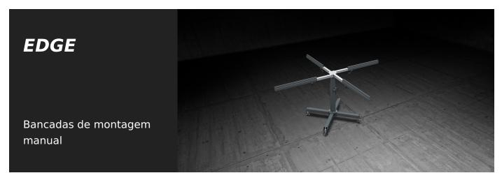
Bancada para a ensamblagem de acessórios e juntas. Giratória sobre um fulcro central e extensível em comprimento, permite virar o quadro.
