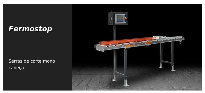
Sistema de comparação da medida e suporte do perfil com o movimento do batente no eixo CN e leitura eletrónica através de banda magnética absoluta. Equipado com sistema eletrónico de medida que permite memorizar os dados na memória interna ou transferi-los em tempo real para uma computador ou para a unidade de controlo de uma máquina de corte através de Bluetooth. Permite usinagens com alta precisão e repetibilidade de posicionamento.
