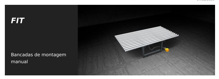
Bancada para a ensamblagem de folhas e marcos. Bancada horizontal com troca pneumática entre o plano de apoio de PVC macio antideslizamento (para a fase de ensamblagem) e o plano de apoio de PVC duro antifricção (para a fase de movimentação). O plano de usinagem é ajustável em altura de 895 a 965 mm. e os pezinhos estão equipados com furos para a sua fixação no solo.
