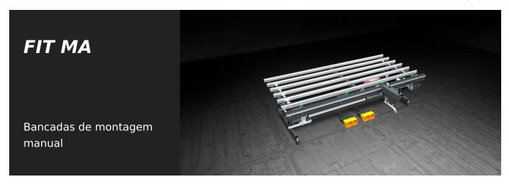
Bancada dedicada à montagem das ferragens perimetrais de fita em folhas de alumínio, madeira e PVC. Um sistema de morsas retráteis bloqueia a folha. A bancada possui um sistema de aparafusamento alimentado de forma automática e, como opção, um sistema para a medição e o corte das ferragens através de guilhotina hidro-pneumática.
