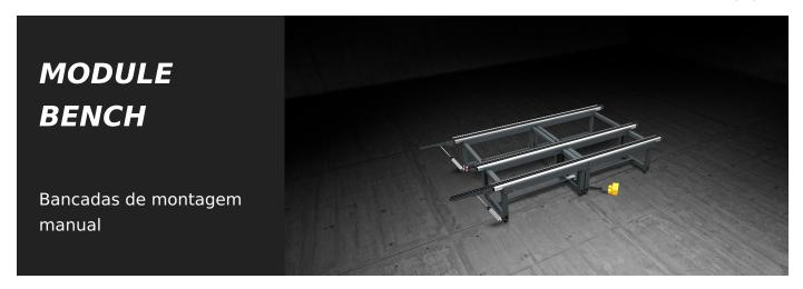
Bancada modular de grandes dimensões, extensível, dedicada à ensamblagem de esquadrias e marcos de fachada. Está implementada com 3 distintos planos de usinagem: um com PVC macio antideslizamento para as operações de ensamblagem, um com PVC duro antifricção para a rotação e um plano de roletes para o deslocamento da linha.
