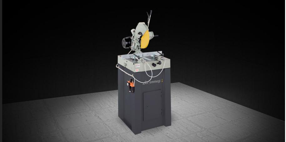
Máquina de corte monocabeça descendente com lado de carga à esquerda, rotação da unidade de corte a 45° (à direita e à esquerda) e basculamento manual a 45° em relação ao eixo horizontal.
