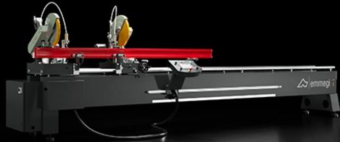
Máquina de corte de cabeça dupla com movimento manual da cabeça móvel e deteção da posição através de barra magnética absoluta. A rotação das unidades de corte no eixo vertical ( $45^\circ$  para a esquerda e para a direita) e a inclinação no eixo horizontal ( $45^\circ$  internos), com regulação manual, permitem cortes combinados também com ângulos intermediários.
