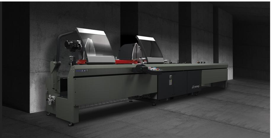
Máquina de corte com cabeça dupla eletrónica e com movimento automático da cabeça móvel através de motor Brushless comandado por controlo numérico. Inclinação pneumática das unidades de corte de 90° até 22°30' (externa) com sistema mecânico de regulação dos ângulos intermédios. Avanço óleo-pneumático do disco de cort
