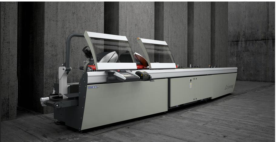
Máquina de corte com cabeça dupla de 3 eixos controlados com movimento automático da cabeça móvel e gestão eletrónica de todos os ângulos de 45° (interiores) a 15° (exteriores) com uma precisão, no interior de cada grau, de 280 posições. O avanço da lâmina é acionado por um par de cilindros óleo-pneumáticos.
