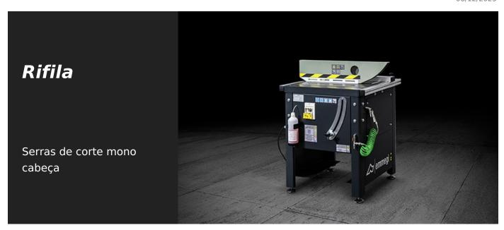
Refiladeira monocabeça, com saída da lâmina de corte ascendente, para perfis extrudados e chapas planas de alumínio. A estrutura particularmente robusta permite obter um corte bem definido e preciso que torna perfeitamente paralelas as faces dos perfis. Além disso, está predisposta para ser equipada com bancadas de rolos de apoio que ampliam a sua versatilidade. A proteção da lâmina de corte foi concebida e realizada para executar usinagens nas melhores condições de segurança.
