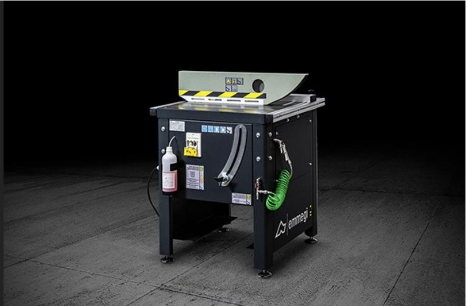
Refiladeira monocabeça, com saída da lâmina de corte ascendente, para perfis extrudados e chapas planas de alumínio. A estrutura particularmente robusta permite obter um corte bem definido e preciso que torna perfeitamente paralelas as faces dos perfis. Além disso, está predisposta para ser equipada com bancadas de rolos de apoio que ampliam a sua versatilidade. A proteção da lâmina de corte foi concebida e realizada para executar usinagens nas melhores condições de segurança.
