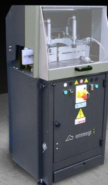
Máquina de corte monocabeça com disco de corte ascendente e lado de carga à esquerda, prevista para ângulos de corte de 15° à esquerda a 15° à direita e ângulos intermediários.
