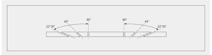
Механическая регулировка промежуточных углов наклона
