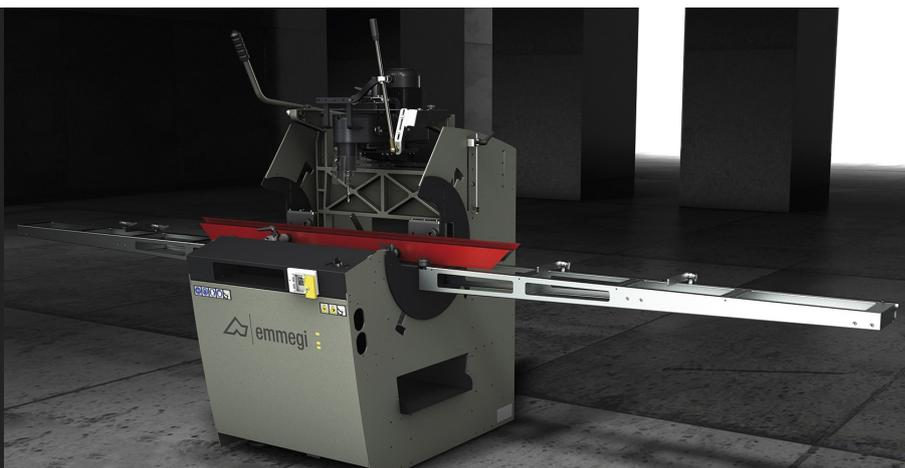
Одноголовочный пантограф с ручным приводом, пневматической блокировкой и перемещением головки с помощью непрямого рычага. Возможность сквозной обработки алюминия без поворота заготовки. Щуп с ручным управлением.
