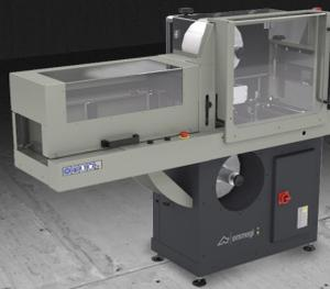
Машина для нанесения защитной пленки на алюминиевые профили. Профиль подается автоматически с помощью моторизованных роликов, а идеальное прилегание пленки к профилю обеспечивается с помощью прижимных роликов. Дополнительный по заказу комплект позволяет одновременно наносить пленку на третью грань профиля.
