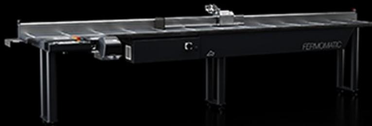
Система размерного упора и опора профиля с движением ограничителя, обеспечиваемым бесщеточным двигателем, и электронным считыванием с помощью абсолютной магнитной полосы. Предлагается в трех вариантах длины для высокоточной обработки с повторяемостью позиционирования.
