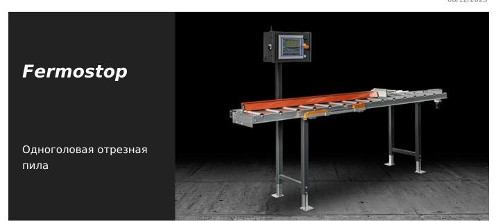
Система размерного упора и опора профиля с движением ограничителя на оси ЧПУ и электронным считыванием, используя абсолютную магнитную полосу. Она оснащена электронной системой измерения, позволяющей сохранять данные во внутренней памяти, либо передавать их в режиме реального времени на ПК или в блок управления пильного станка посредством Bluetooth. Это позволяет выполнять обработку с высокой точностью и повторяемостью позиционирования.
