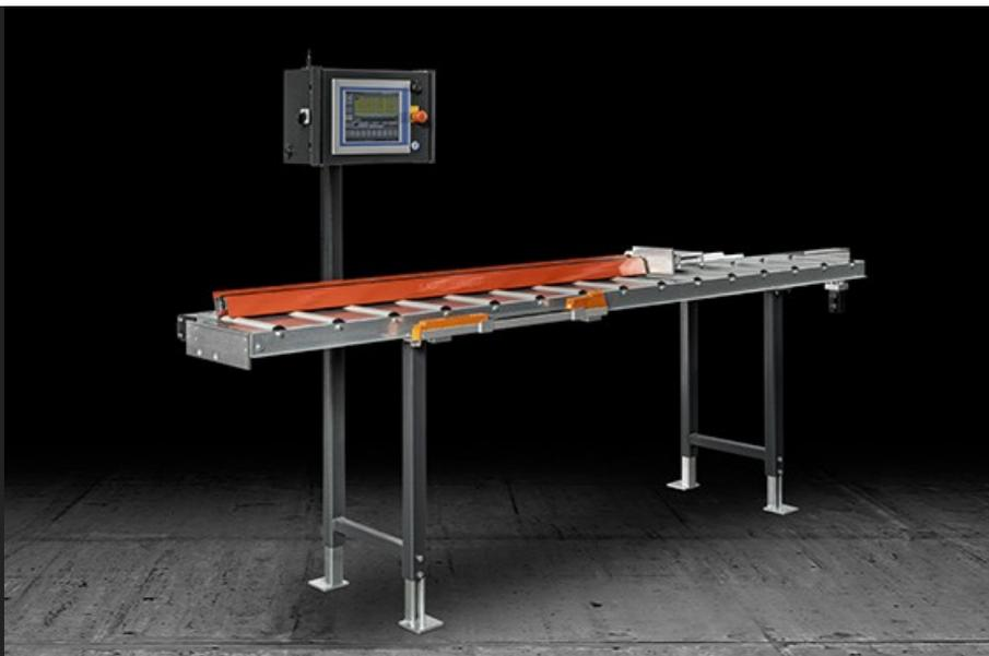
Система размерного упора и опоры профиля с движением ограничителя на оси ЧПУ и электронным считыванием, используя абсолютную магнитную полосу. Она оснащена электронной системой измерения, позволяющей сохранять данные во внутренней памяти, либо передавать их в режиме реального времени на ПК или в блок управления пильного станка посредством Bluetooth. Это позволяет выполнять обработку с высокой точностью и повторяемостью позиционирования.
