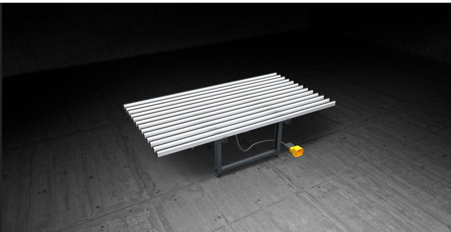
Сборочный стол для створок и рам. Горизонтальная рабочая поверхность с пневматической сменой опорных столов, покрытым мягким противоскользящим ПВХ (для этапа монтажа и сборки) и покрытым твердым антифрикционным ПВХ (для этапа перемещения). Рабочий стол регулируется по высоте в диапазоне от 895 до 965 мм, а опорные ножки оборудованы отверстиями для крепления к полу.
