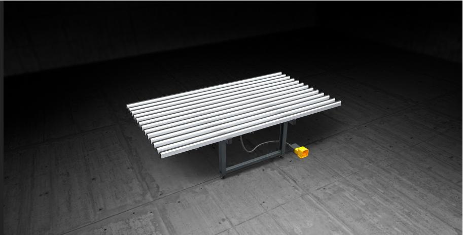
Сборочный стол для створок и рам. Горизонтальная рабочая поверхность с пневматической сменой опорных столов, покрытым мягким противоскользящим ПВХ (для этапа монтажа и сборки) и покрытым твердым антифрикционным ПВХ (для этапа перемещения). Рабочий стол регулируется по высоте в диапазоне от 895 до 965 мм, а опорные ножки оборудованы отверстиями для крепления к полу.
