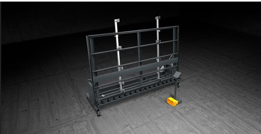
Испытательный стенд для алюминиевых переплетных конструкций. Он позволяет воссоздать условия эксплуатации переплетных конструкций: рама блокируется с помощью системы зажимов, регулируемых по всей высоте рамного переплета, внутрь рамы вставляются створки, стекла и производится окончательное испытание. Рольганг позволяет оператору загружать и разгружать тяжелые модули в режиме полной автономии.
